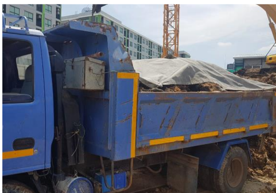
รูปที่ 5 การปิดคลุมรถบรรทุกขนส่ง
